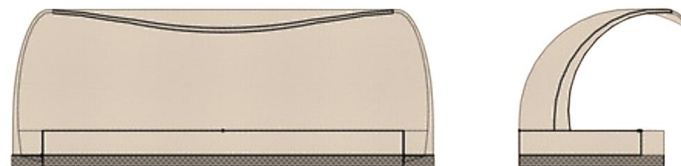
Figura 55. Vistas de la cáscara de concreto
