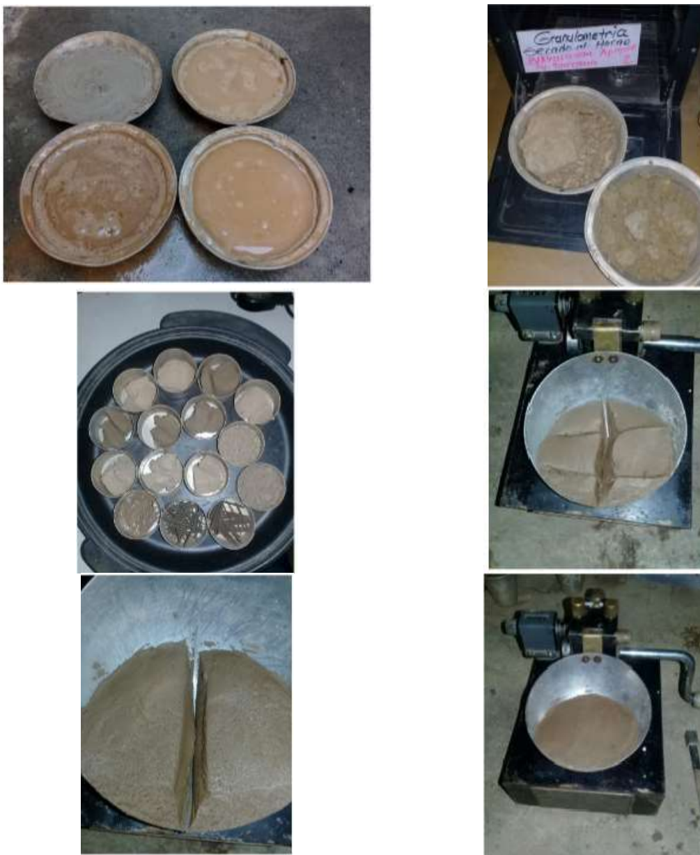
Ilustración 7.8 Ensayo de laboratorio, granulometría y límites de atterberg Fuente: Autores
