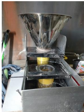
Figura 22. Tolva y estructura principal, fuente: fotografía propia
