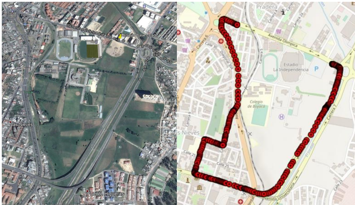
Figura 62: Ruta generada por la Estación Base ubicada cerca al Estadio de la Independencia (Izquierda) y Ruta generada por el sistema implementado en el vehículo (Derecha). Fuente: Autores.
