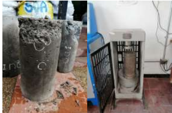
Figura 36 Fallas cilindros 28 días, N-C5%.
