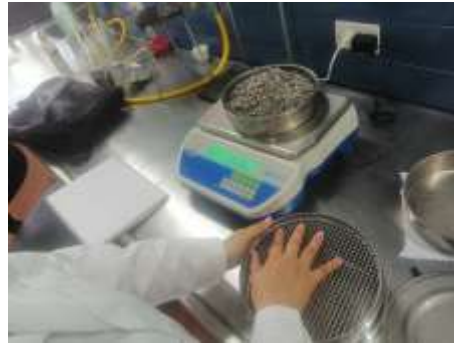
Figura 12 Tamizado y peso del material del tamiz de 4.75 mm
