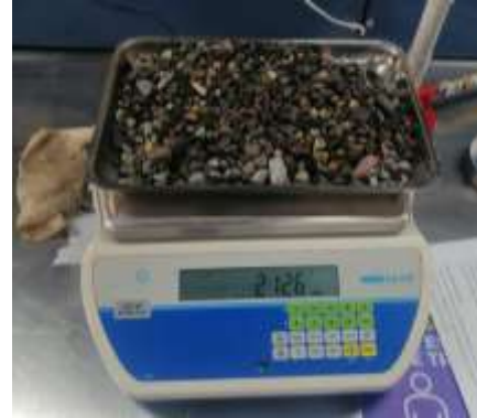
Figura 15 Peso agregado grueso saturado.
