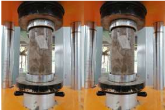
Figura 32 Fallas cilindros 7 días, N-C5%.
