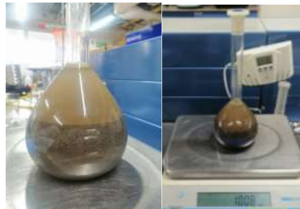
Figura 25 Peso picnómetro con la muestra sin vacíos.
