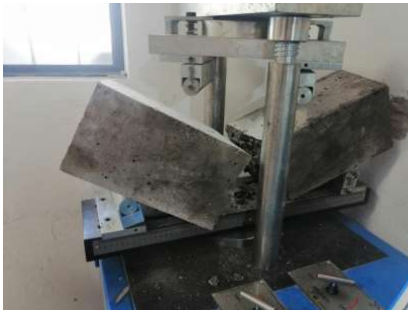
Figura 59 Ensayo Resistencia Concreto a Flexión.
