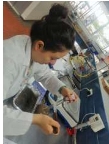
Figura 23 Agregado fino introducido en el picnómetro.
