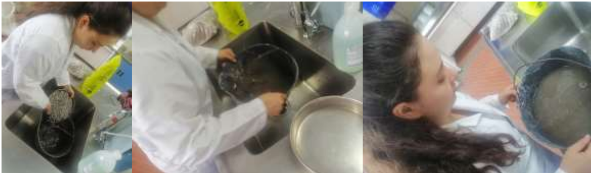
Figura 13 Agregado grueso sumergido.
