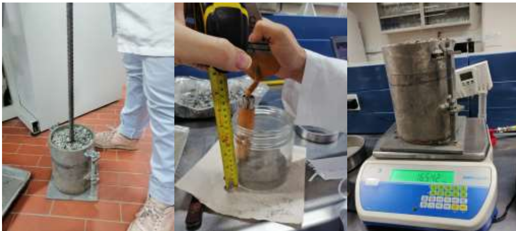
Figura 26 Llenado de moldes y peso.
