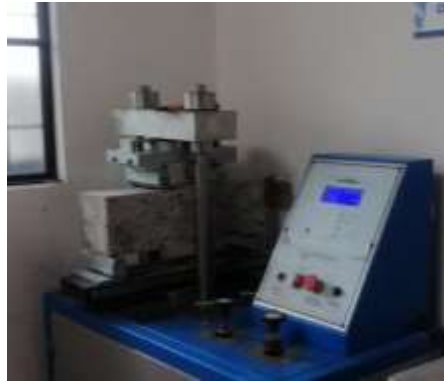
Figura 43 Ensayo Resistencia Concreto a Flexión.
