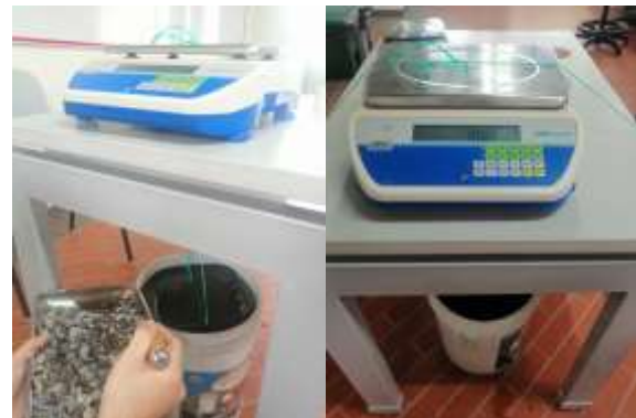
Figura 17 Peso material grueso sumergido.
