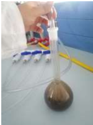
Figura 24 Extracción de vacíos.
