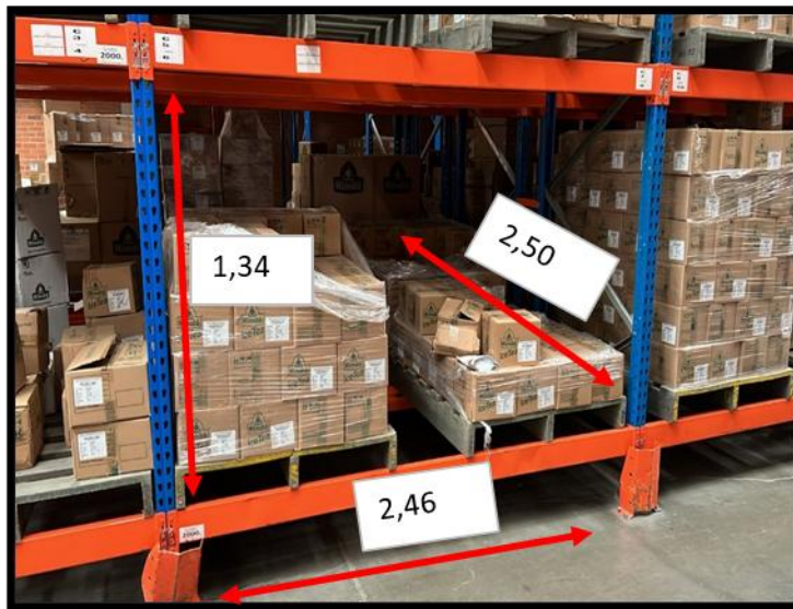
Ilustración 11 Especificaciones correspondientes al Rack C
