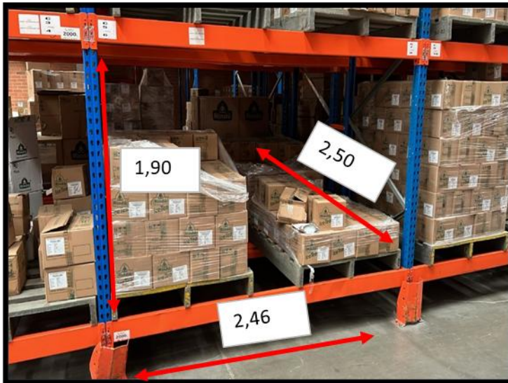
Ilustración 12 Especificaciones correspondientes al Rack D sección azul
