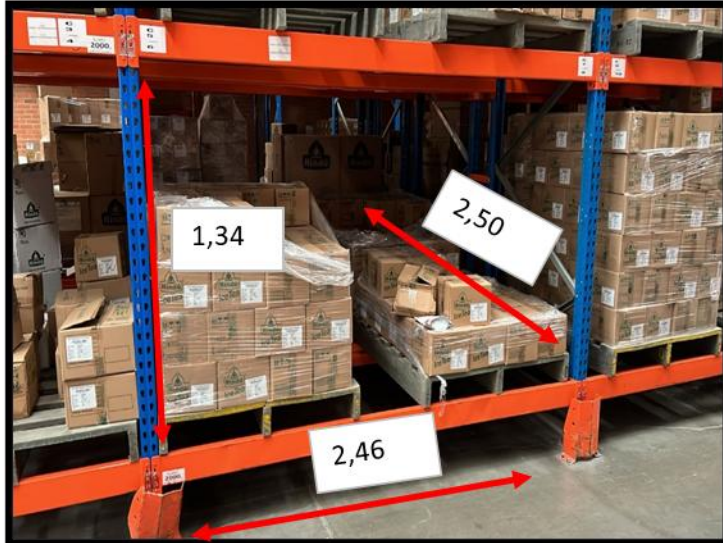
Ilustración 13 Especificaciones correspondientes al Rack D sección amarilla
