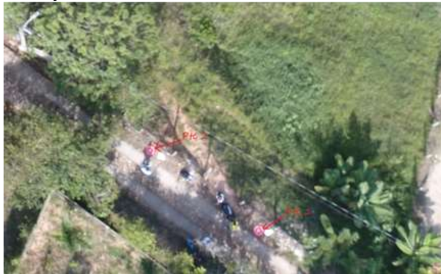
Figura 12. Ubicación puntos de control en el terreno
