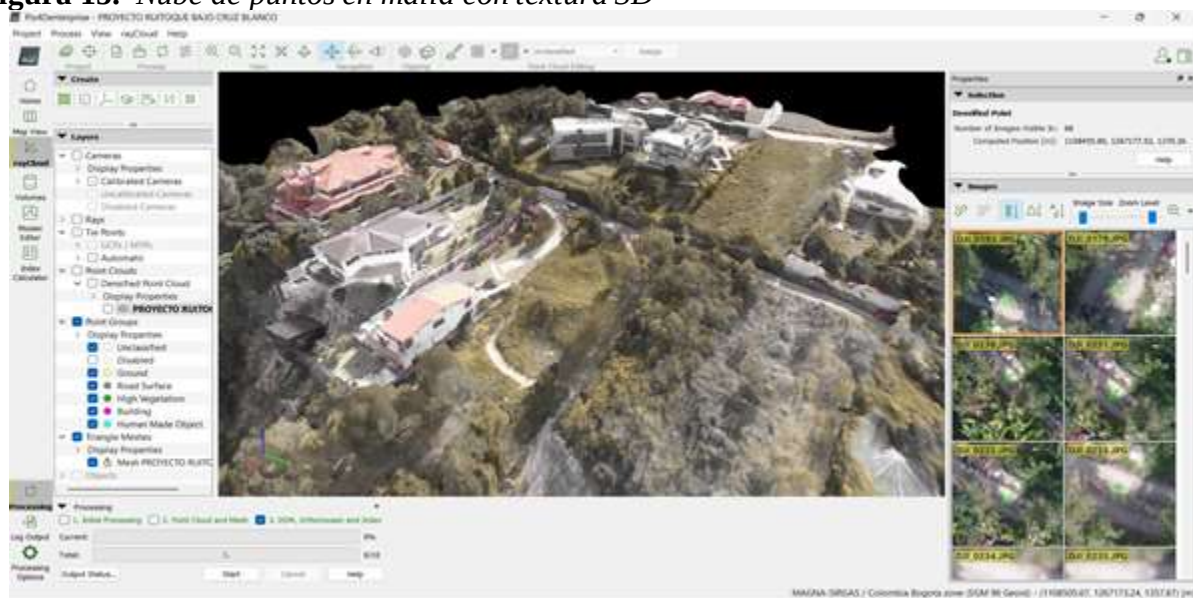
Figura 15. Nube de puntos en malla con textura 3D
