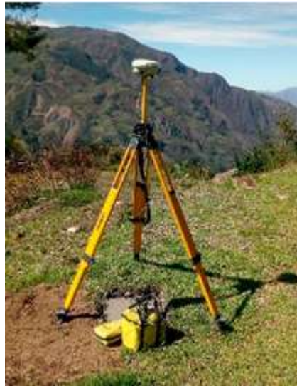
Figura 11. GPS de alta precisión con antena ubicado en el terreno
