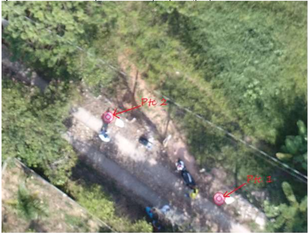
Apéndice E. Foto aérea con puntos de control plataformas guía para escalar
