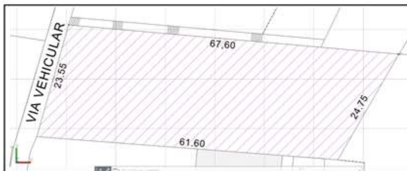
Figura 25. Información de las medidas constatadas con el método de cinta métrica en el sitio
