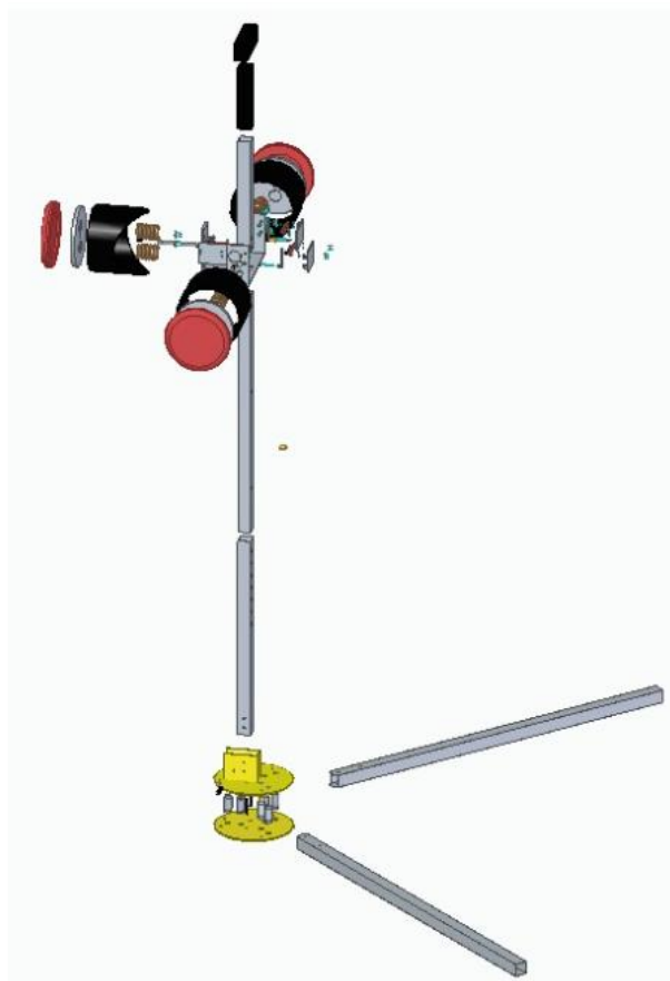
Figura 42. Ensamble CAD y explosionado Fuente: Autores
