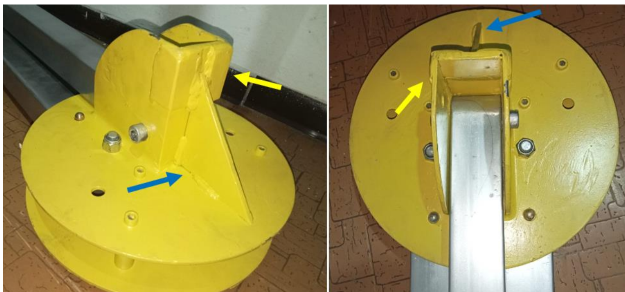
Figura 60. Mejoras en la estructura, base soporte superior, nervio y refuerzo. Fuente: Autores
