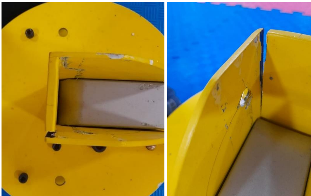
Figura 56. Fallas en la estructura, base soporte superior. Fuente: Autores
