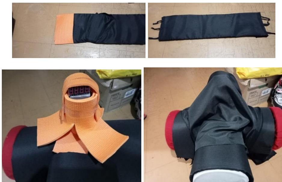
Figura 51. Cubierta de espuma adicional. Fuente: Autores
