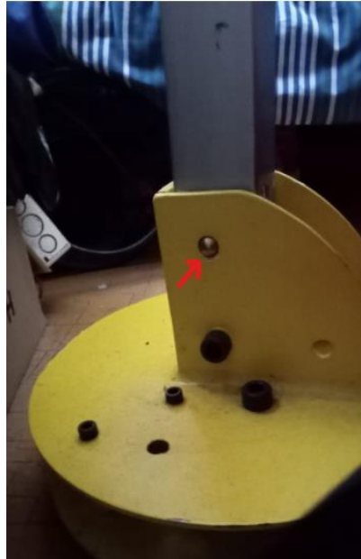
Figura 33. Pin seguro soporte vertical. Fuente: Autores
