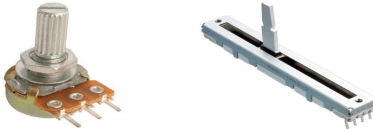
Figura 5. Potenciómetros “rotacional” (izquierda) y “deslizante” (derecha). Fuentes: https://comofunciona.co/un-potenciometro/ (izquierda) y https://www.ebay.es/itm/351409770511 (derecha)
