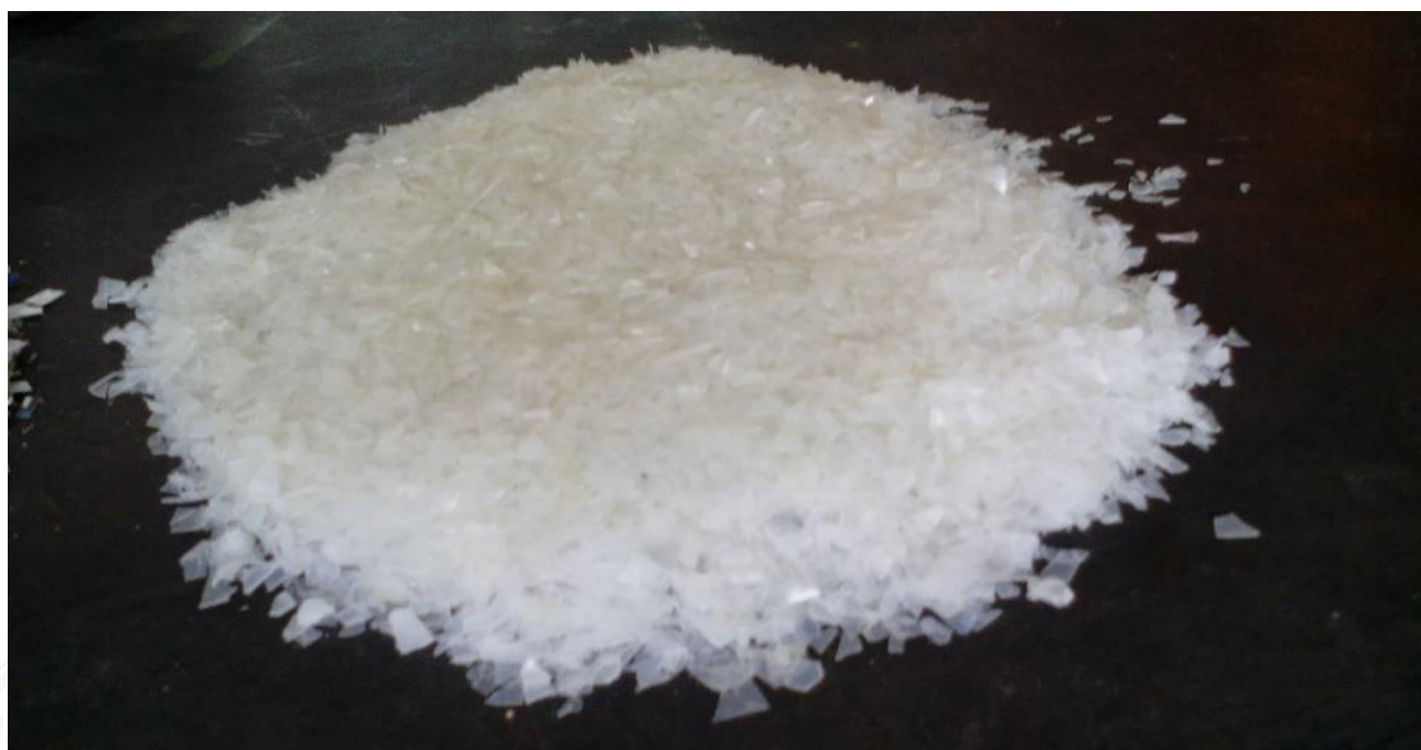
Figura 4: Tetra-pack y Botellas plásticas de PET triturados antes de mezclarse y ser llevados a la plancha térmica.
