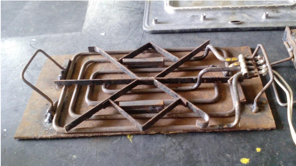
Figura 5: Plancha térmica, vista superior donde se observan las resistencias encargadas de calentar y fundir los materiales en láminas de triturado.
