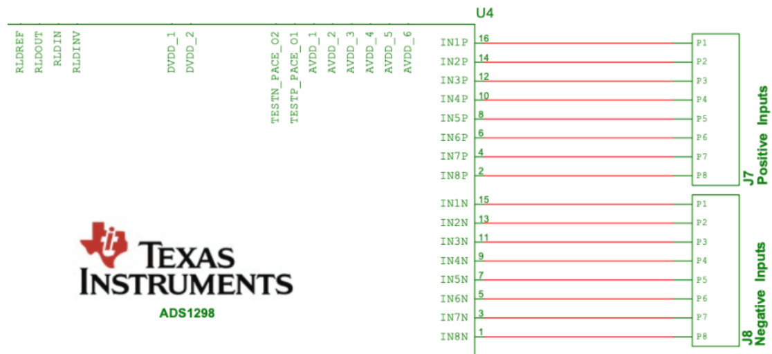
Figura 38. Conexiones a las terminales de entrada del ADS1298. Fuente: Autor.
