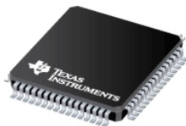
Figura 34. Circuito integrado ADS1298. [45]
