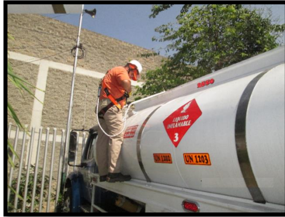
Ilustración 2 Descargue de combustible. Elaboración propia.
