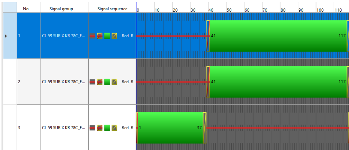
Figura 76 Tiempo de fases CL 59 SUR X KR 78C Fuente: Elaboración propia a partir software Vissim student
