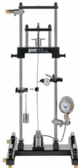
Figura 1. Instrumento de prueba para el efecto de pandeo WP120 Pandeo de Barras.
