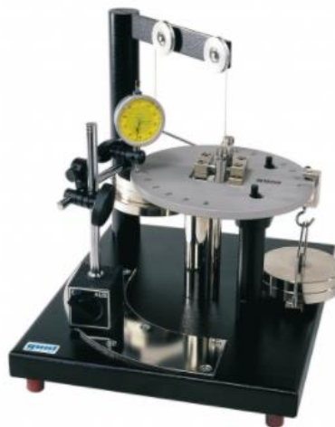
Figura 2. Instrumento de prueba para la comprobación de pruebas de hipótesis de tensión WP 130.
