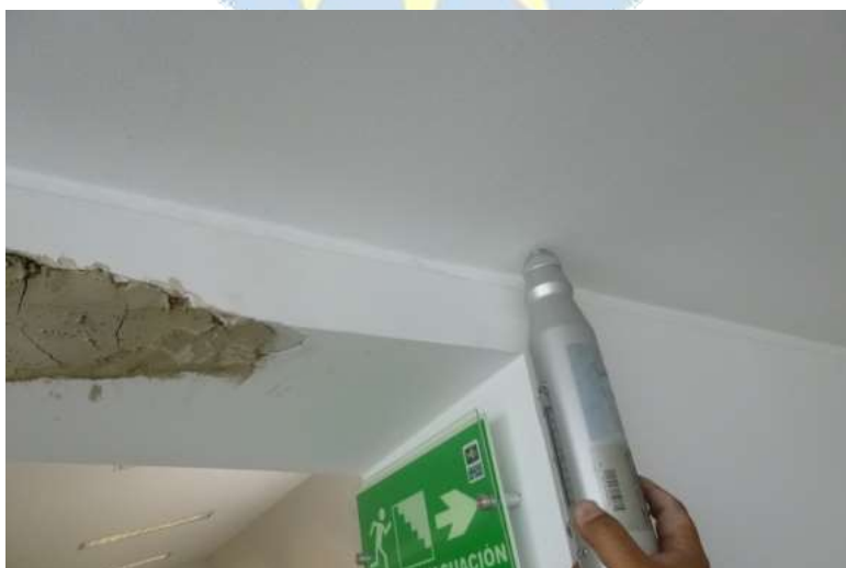
Imagen 54. Ensayo de Esclerometria en Placa
