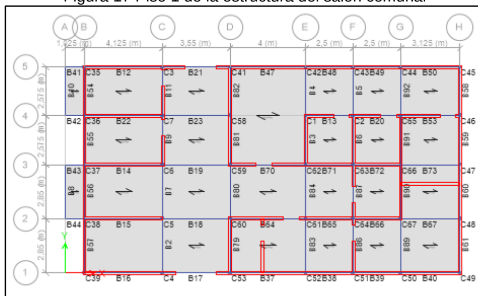
Figura 17 Piso 1 de la estructura del salón comunal
