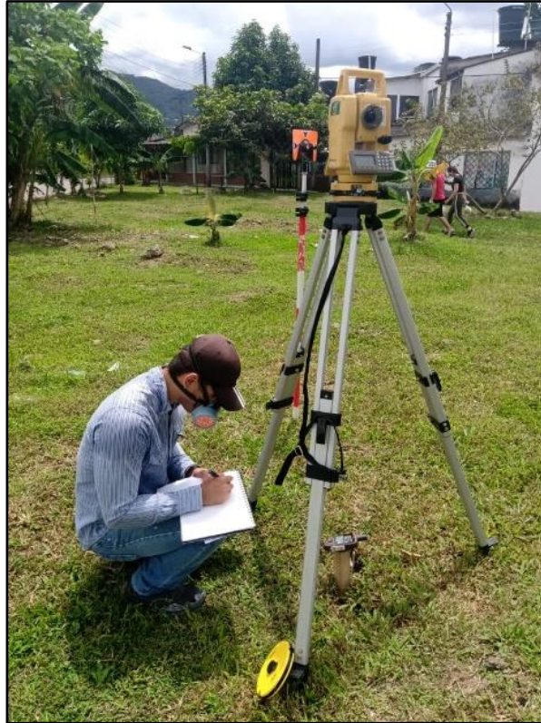
Figura 3 Armado del punto delta con la estación total
