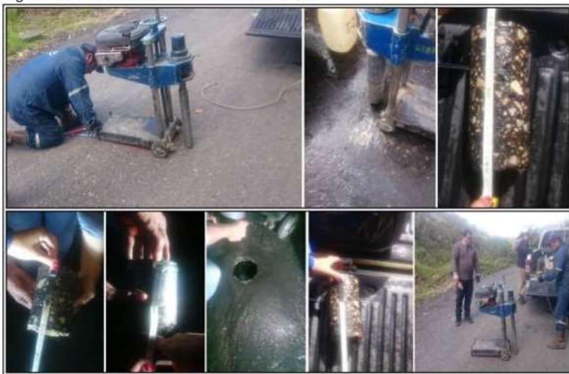
Figura 43. Proceso de extracción de núcleos.
