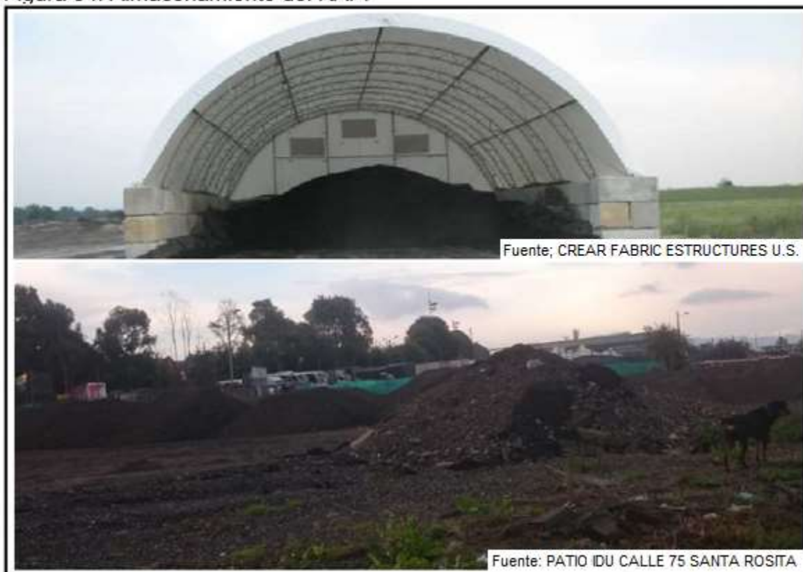
Figura 34. Almacenamiento del RAP.
