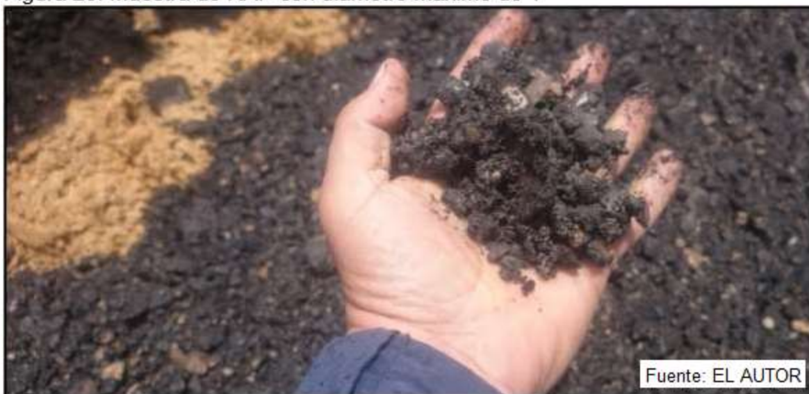
Figura 25. Muestra de RAP con diámetro máximo de 1"
