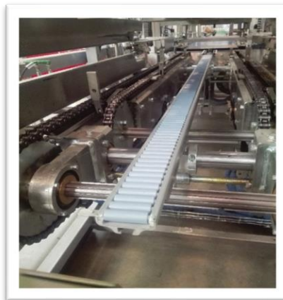
Figura 16. Eje central de encartonado línea uno mal alineado.
