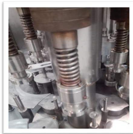
Figura 4. Eje de tapado del tribloque, con corrosión y oxidación
