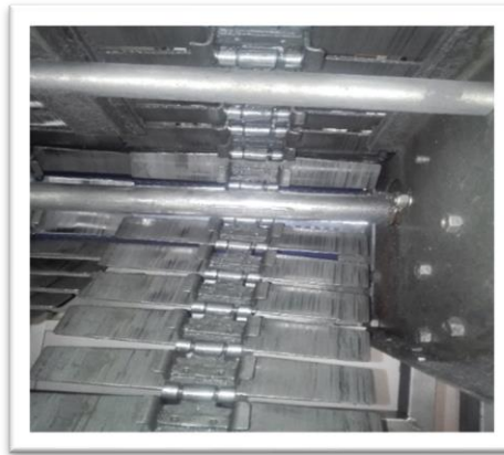
Figura 3. Cadena de transporte de la curva uno, con falta de lubricación y desgaste.
