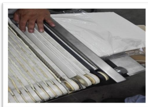
Figura 12. Filtro prensa con problema de compresión.
