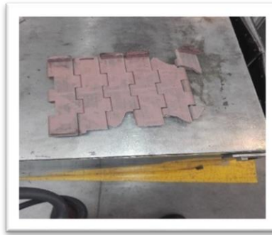
Figura 20. Ruptura de cadena por mala alineación en línea de termo encogible.
