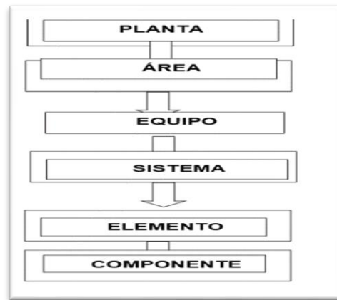
Figura 21. Estructura de clasificación de componentes en la planta según Metodología RCM.
