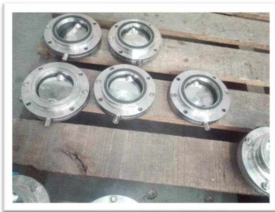
Figura 9. Válvulas de paso del tanque pulmón de la línea uno con los empaques averiados por presión.
