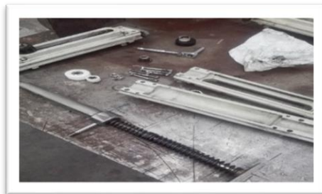
Figura 10. Sistema interno de elevación de la llenadora.
