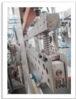
Figura 5. Selladora con desgaste en cuchillas.
