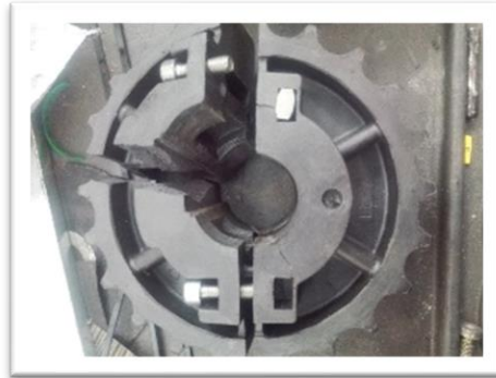
Figura 13. Engranaje con fractura, por mala alineación perteneciente a la línea de transporte uno.
