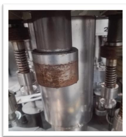
Figura 4. Eje de tapado del tribloque, con corrosión y oxidación
