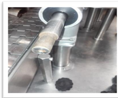
Figura 18. Eje central de tornillo sin fin con oxidación y falta de lubricación.
