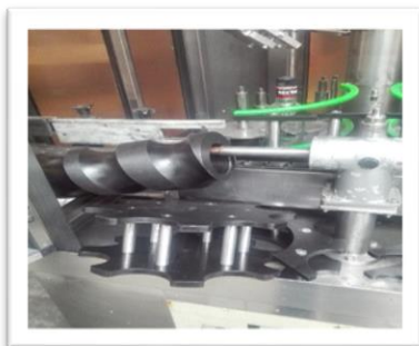
Figura 6. Eje de tornillo sin fin sistema de transporte uno con oxidación y desgaste.
