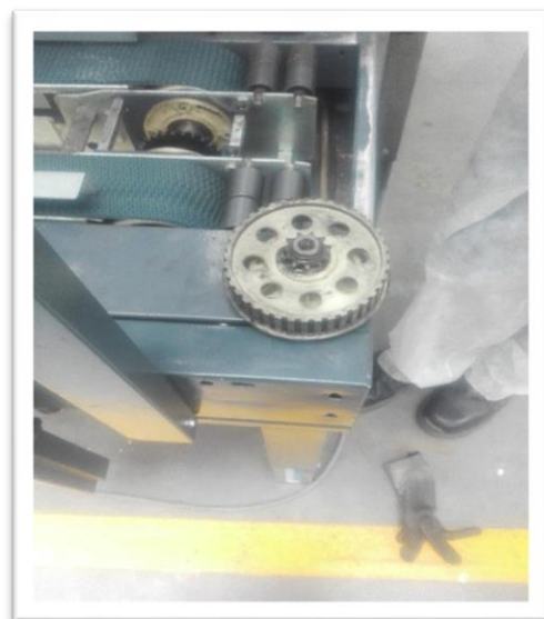
Figura 24. Cambio de engrane de la encintadora en la línea uno por corrosión y ruptura.
