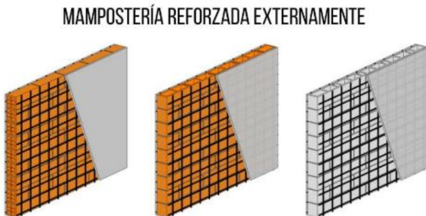
Figura 21. Mampostería reforzada externamente
