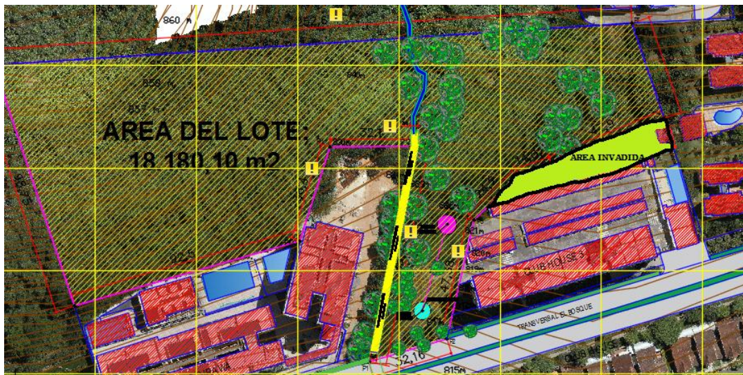
Figura 20. Información obtenida del posproceso a partir de puntos de control y el escalamiento del ortomosaico
