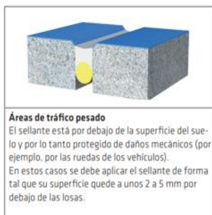
Figura 36. Recomendaciones en el sellado de juntas.
