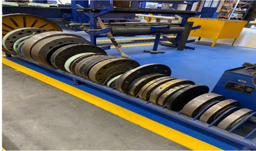
Figura 13. Estado actual de los dispositivos para pruebas hidrostáticas.
