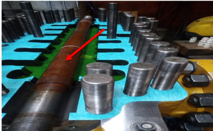
Figura 27. Método de montaje anterior para pruebas hidrostáticas
