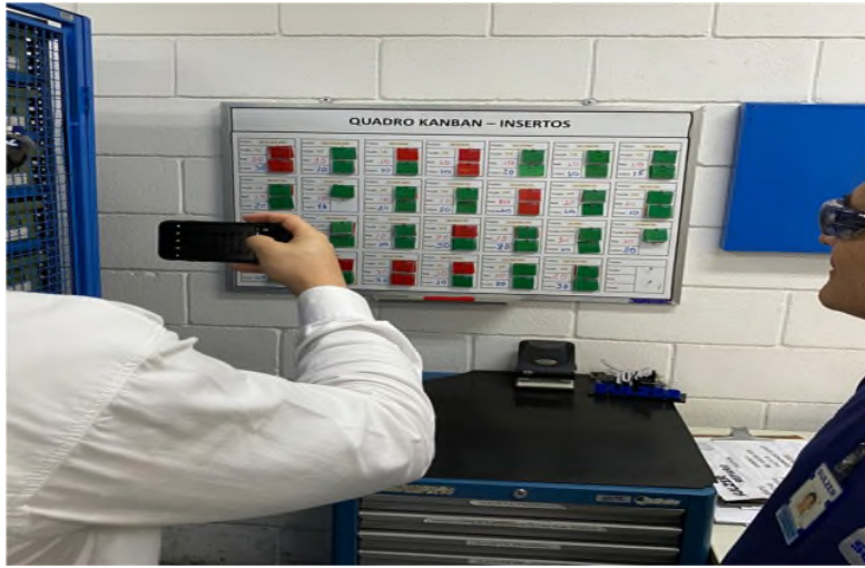
Figura 47. Ejemplo de implementación cuadro Kanban para control de insertos.
