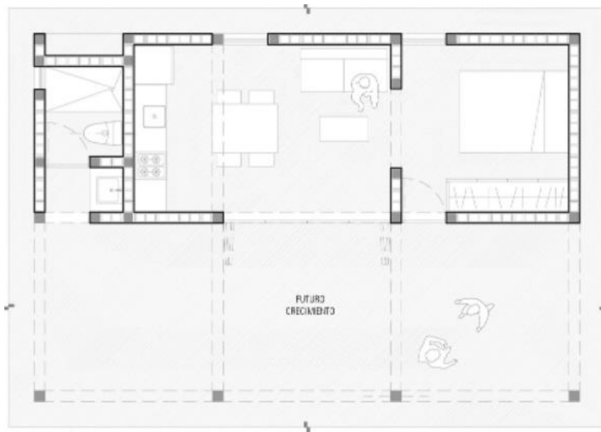
Figura 17. Planta vivienda tipo, La casa que crece
