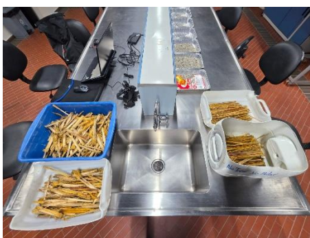
Figura 34 Secciones de fibra de guadua para sumergir en NaOH 1%
