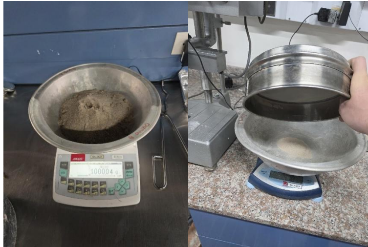
Figura 40 Muestra de arena para tamizar y realizar la granulometría
