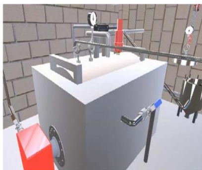
Figura 2 Fuente de vapor utilizada en el proceso de explosión súbita de vapor.
