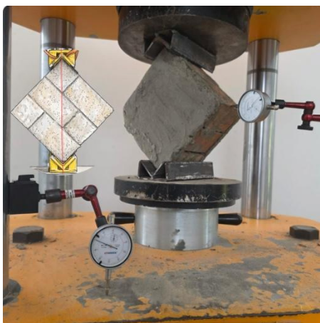
Figura 58 Adaptación de los soportes de carga para el ensayo de muretes según la NTC 4925
