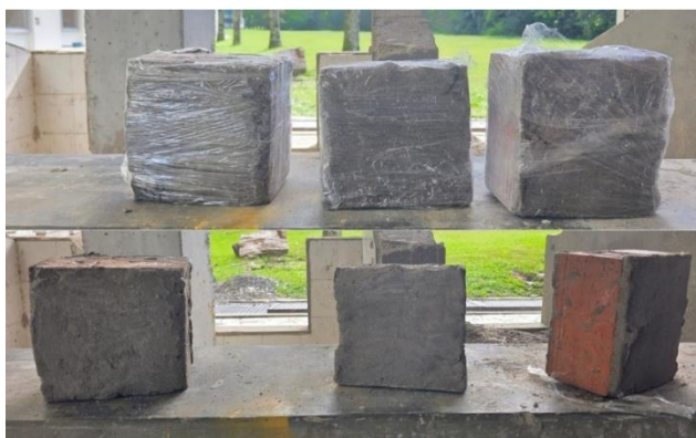
Figura 61 Muretes tras 28 días de curado listos para el ensayo.
