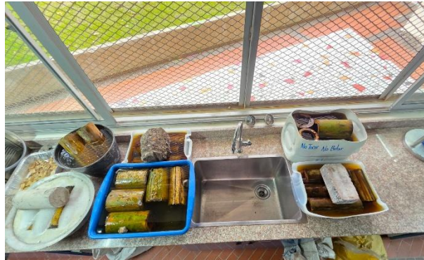
Figura 27 Entrenudos sumergidos en NaOH por 5 días.
