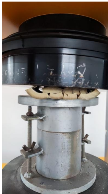
Figura 32 Método CMT con maquina universal.
