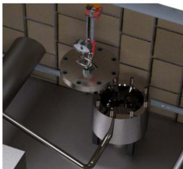
Figura 2 Reactor de explosión súbita de vapor.
