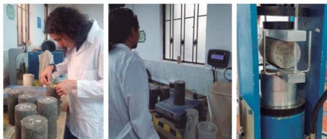
Figura 9 Proceso de ensayo a tracción indirecta.
