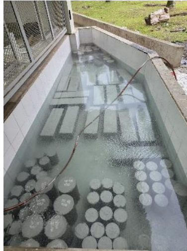
Figura 52 Curado de especímenes cilíndricos y vigas de concreto por inmersión.
