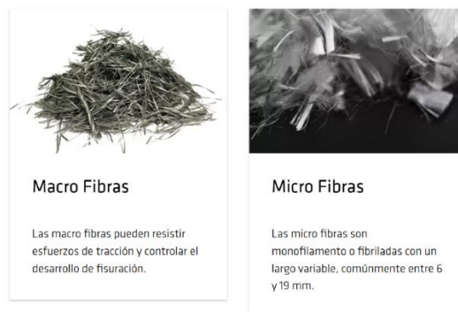
Figura 17 Clasificación de fibras para concreto: macrofibras y microfibras sintéticas.
