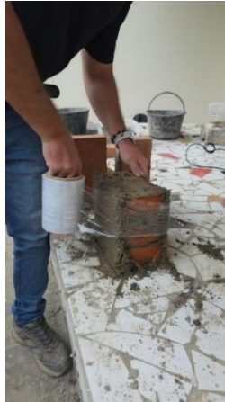
Figura 43 Cubrimiento de los muretes con plástico vinipel
