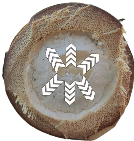
Figura 14 Orientación de los haces vasculares en el culmo de Guadua angustifolia : disposición transversal
