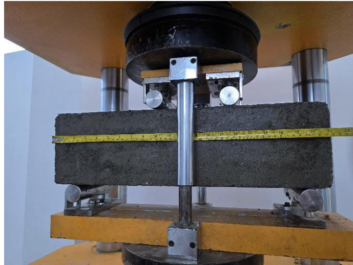
Figura 60 Medición de una cara de la viga para el trazado del tercio central
