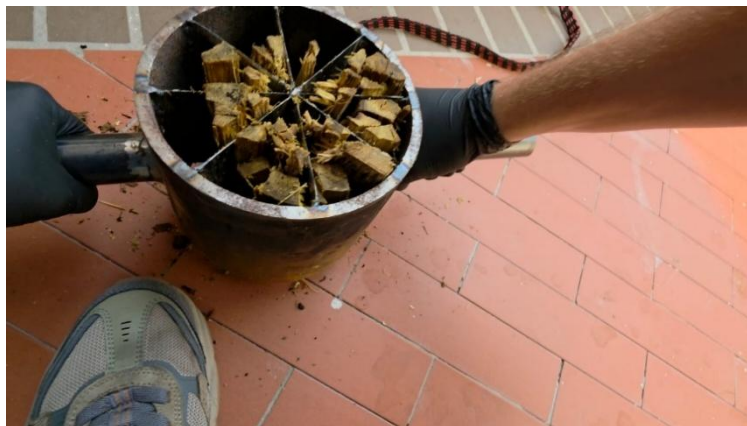
Figura 31 Cortador de secciones de guadua
