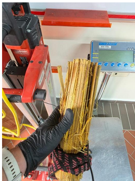
Figura 33 Secciones de fibra amarradas para utilizar el cortador de secciones.
