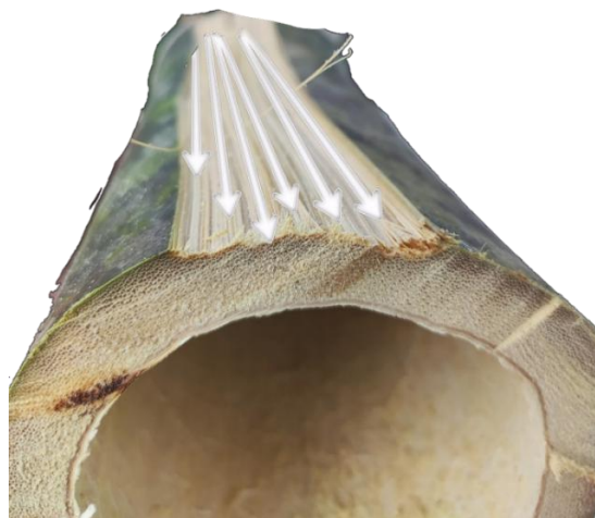
Figura 15 Orientación de los haces vasculares en el culmo de Guadua angustifolia : disposición axial en el internodo.
