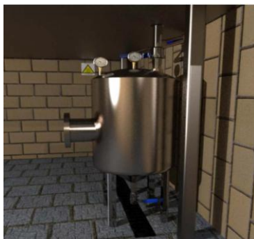
Figura 3 Reactor del sistema de explosión súbita de vapor.
