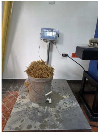
Figura 50 Pesaje del refuerzo de fibra de 5cm de longitud
