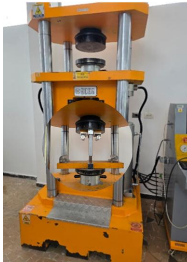
Figura 56 Máquina universal ALFA UTM-001/LCD de 2000 kN con accesorio de tercios medios
