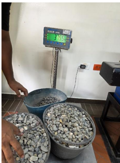
Figura 49 Pesaje de agregado según tamaño requerido
