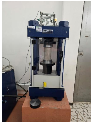
Figura 57 Máquina Matest Automatic C025A equipada con accesorio extensómetro C133
