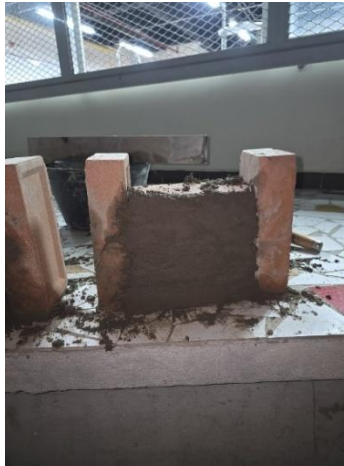
Figura 47 Murete con adición de fibra al 0,5 %
