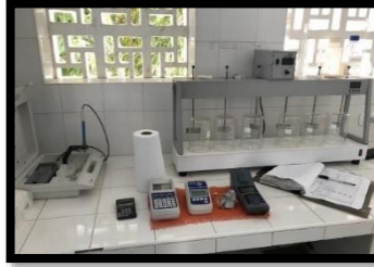
Imagen 13. Ensayo de Jarras en cuarto de dosificación.
