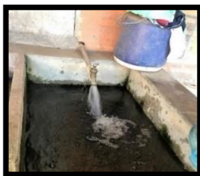
Imagen 23. Verificación de material granular en grifo del predio.
