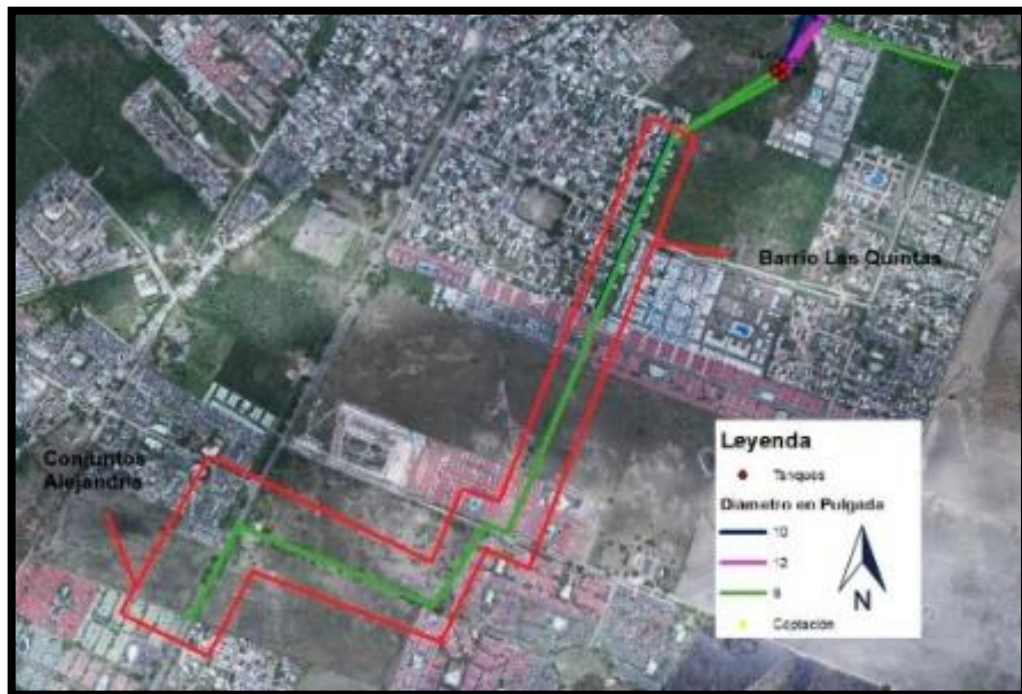
Imagen 10. Tubería PEAD de 8 pulgadas desde el Barrio Las Quintas hasta Conjuntos Alejandría.
