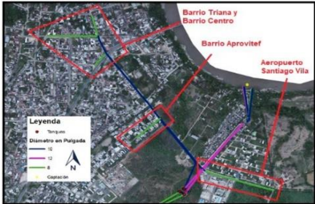
Imagen 9. Tubería PEAD de 8 pulgadas en el Barrio Triana, Barrio Centro, Barrio Aprovef, y Aeropuerto Santiago Vila.
