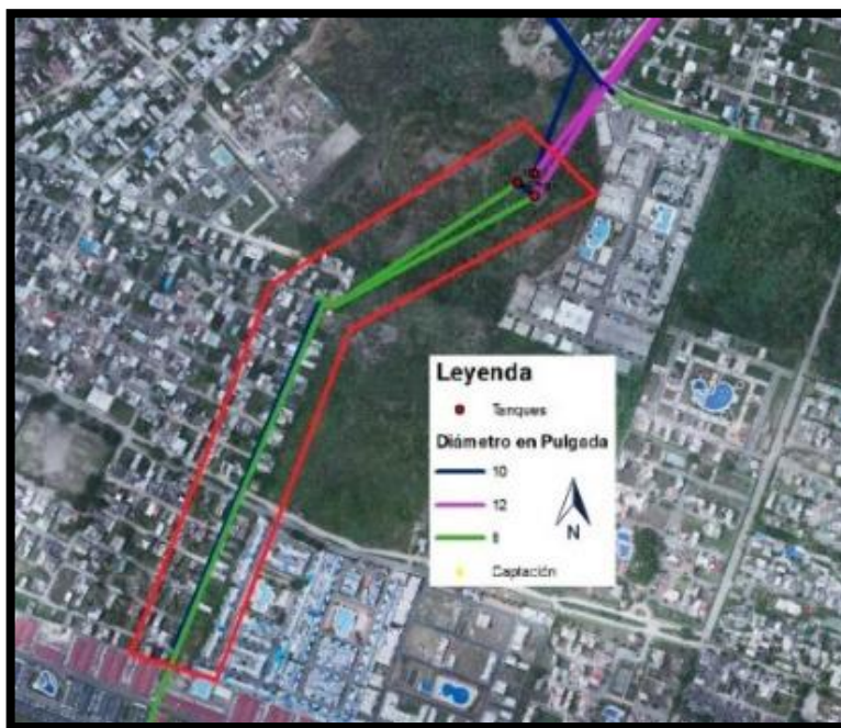
Imagen 8. Red matriz de agua potable que va hasta el Barrio Las Quintas, tubería PEAD de 10 pulgadas.
