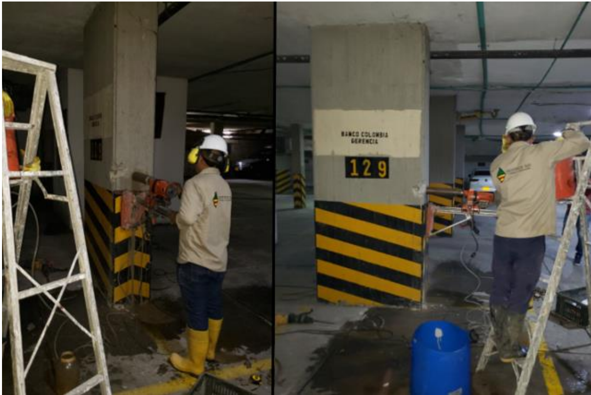
Figura 28 Extracción de Núcleos
