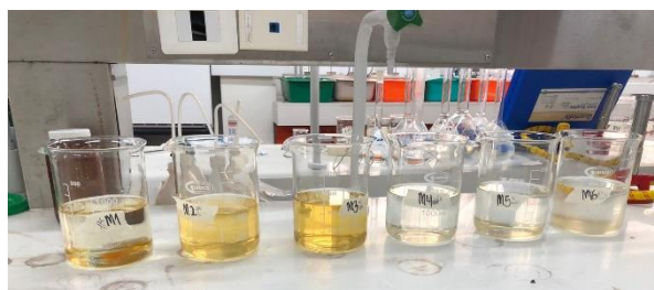
Figura 37. Prueba de jarras muestras aceptables.
