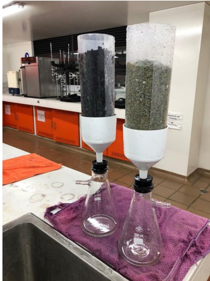
Figura 18. Montaje de filtración
