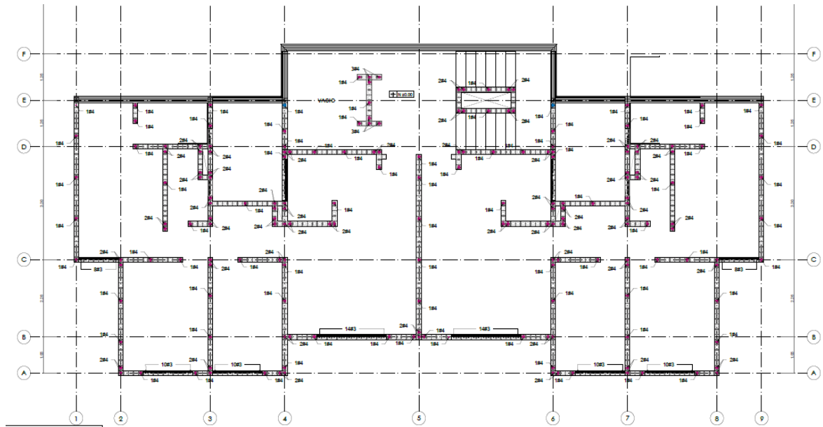
Figura 23. Refuerzo en la mampostería estructural
