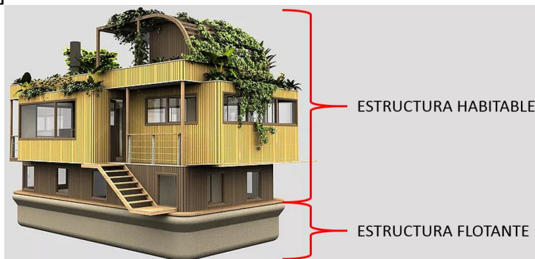
Figura 6.1 Composición de una vivienda flotante
