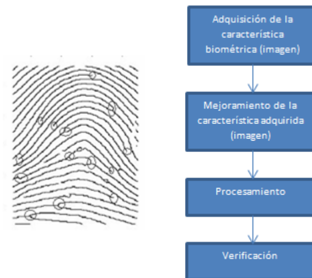
Imagen 6.2 – Diagrama de flujo del sistema de reconocimiento biométrico.
