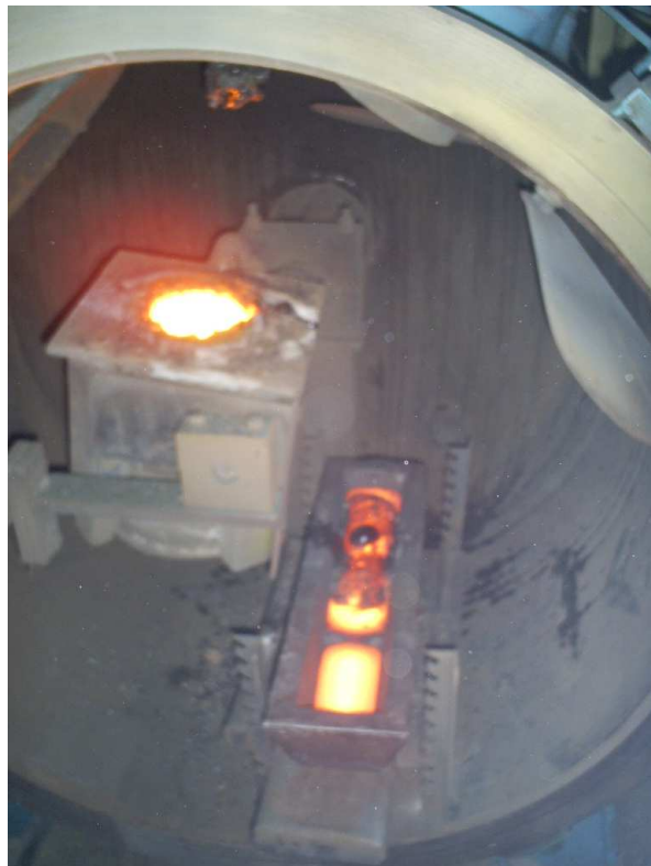
Figura 7. Lingotera con material fundido.
