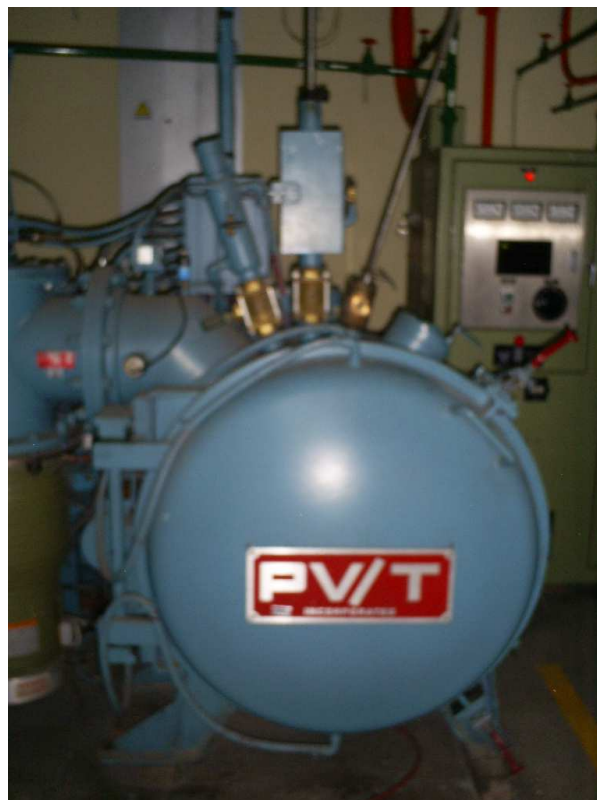
Figura 4. Horno eléctrico de inducción.
