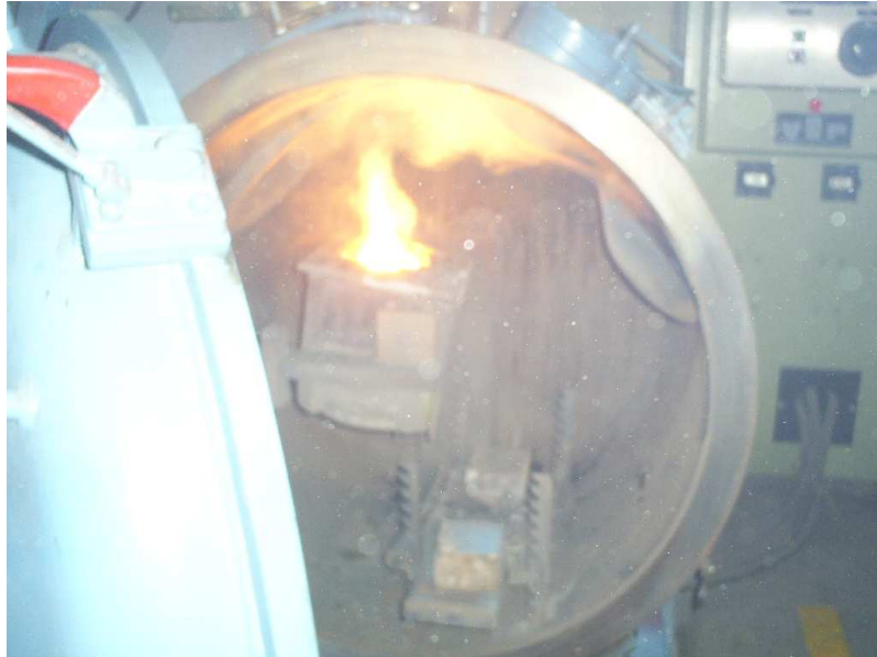
Figura 7. Lingotera con material fundido.
