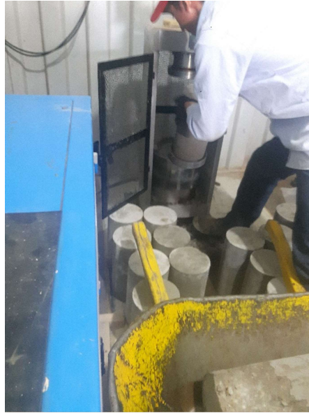
Imagen 6: Montaje Para Ensayo De Compresión Uniaxial Fuente: Propia.
