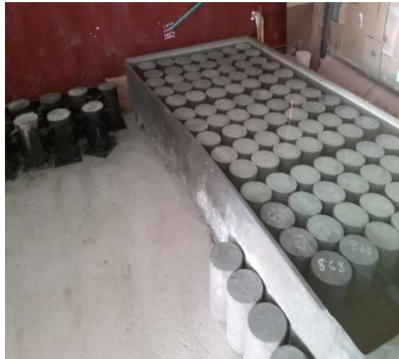
Imagen 5: Curado De Muestras De Concreto Fuente: Propia.
