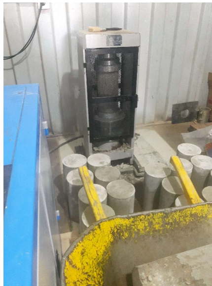
Figura 7: Montaje Para Ensayo De Compresión Uniaxial Fuente: Propia.
