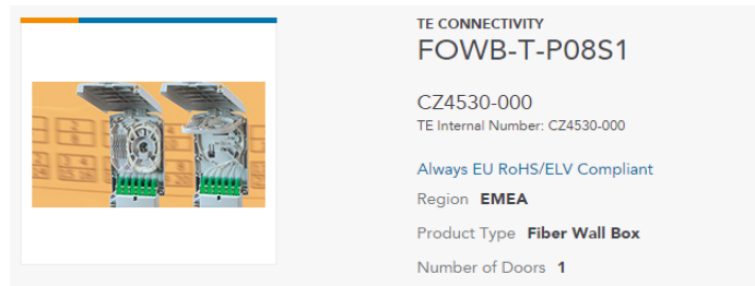
FIGURA 50. CAJA DE CONEXIÓN DE FIBRA OPTICA
