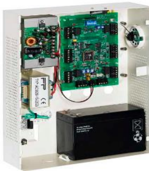
FIGURA 82. CONTROLADORA DE ACCESOS ROSSLARE
