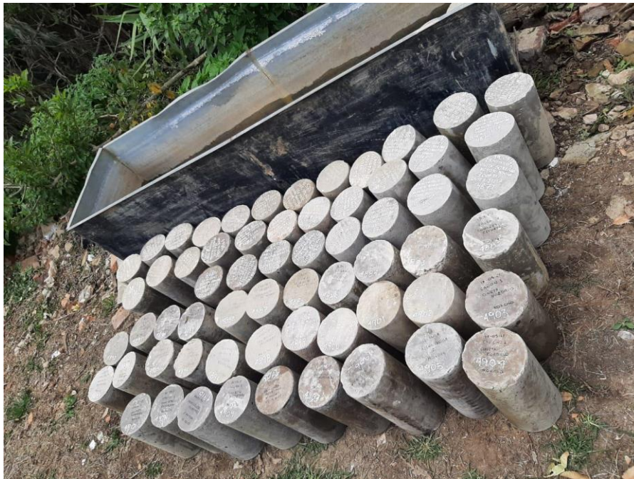
Figura 13: Cilindros de concreto para falla. Fuente: Autor
