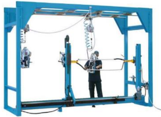
Figura 18. Estructura metálica para maquina BCT 20/50
