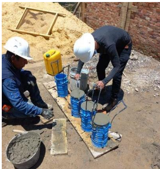
Imagen 19: Elaboración de especímenes de concreto de viga de amarre sobre muro, para ensayo de resistencia a la compresión del concreto.
