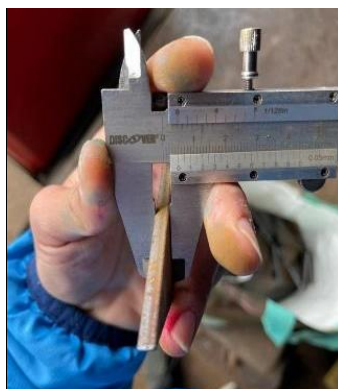
Imagen 22: Revisión de calibres de materiales para la elaboración de los módulos de cerramiento.
