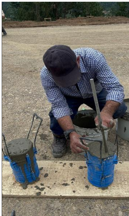
Imagen 10:Elaboración de ensayos para concreto de zapatas y vigas de cimentación.
