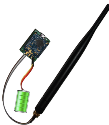
Figura 13. Equipo Router Fuente: Propia
