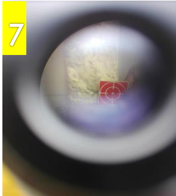
Fotografía 4: Toma de Puntos de verticalidad
