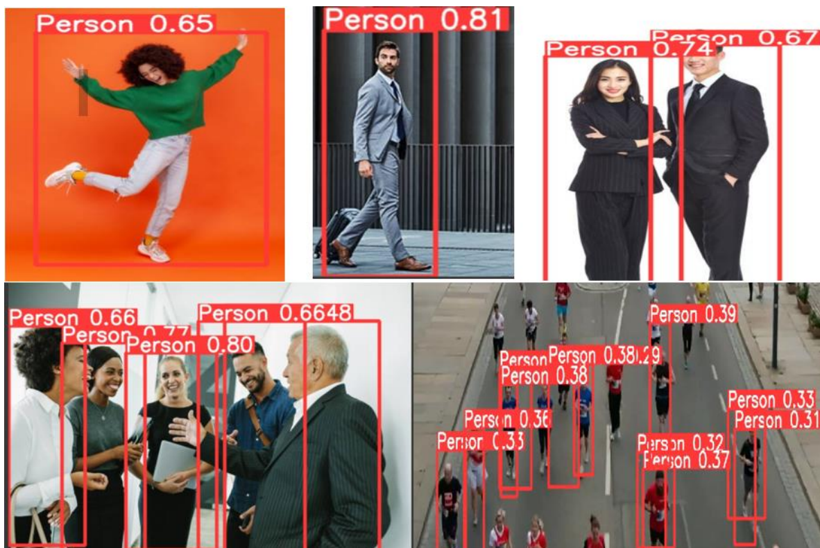
Figura 24. Resultados de detección de imágenes del modelo de ML usando YOLOv5
