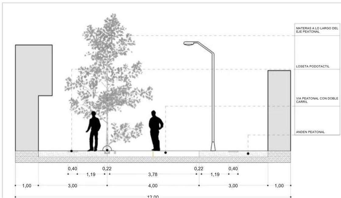
Figura 45. Perfiles viales existentes.
