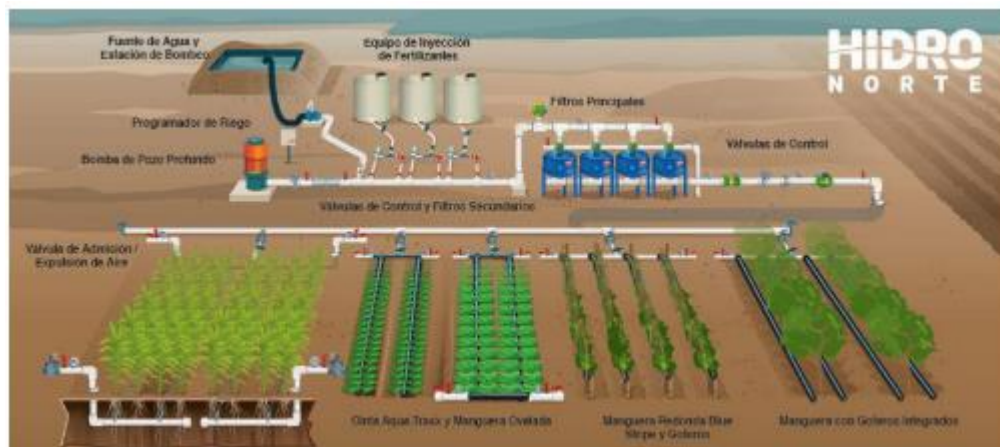
Imagen 3. Esquema de un sistema de riego presurizado
