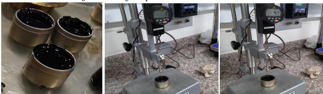
Figura 5 Ensayo de penetración de material bituminoso
