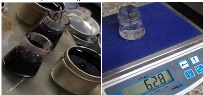
Figura 6 Ensayo de densidad del material bituminoso
