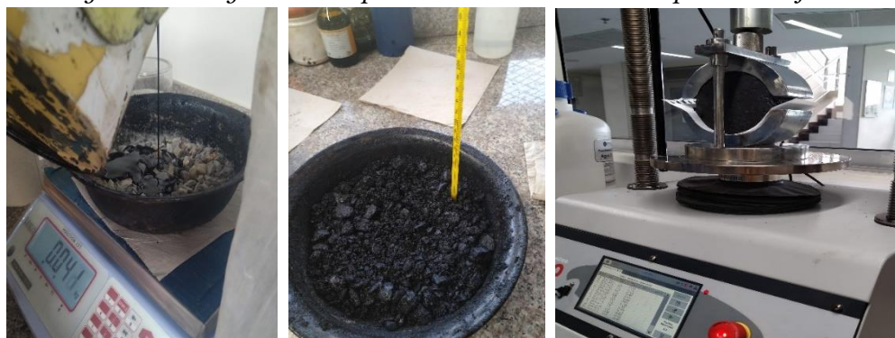
Figura 10 Ensayo Marshall para determinar contenido óptimo de asfalto
