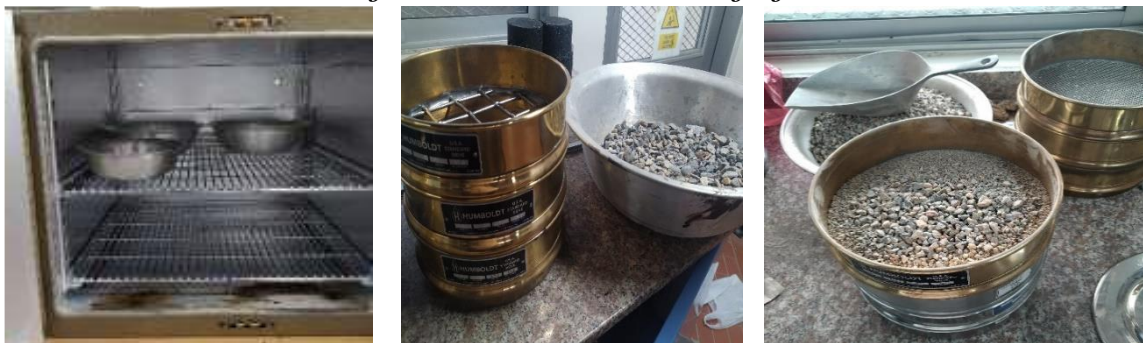
Figura 4 Granulometría de los agregados
