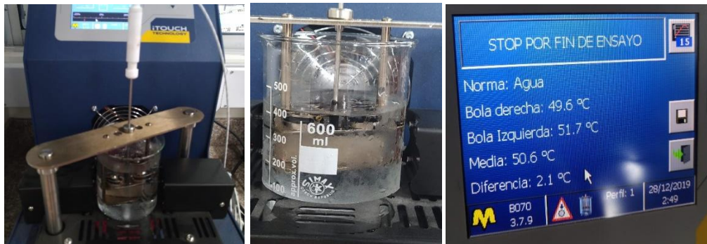
Figura 8 Ensayo de punto de ablandamiento (método anillo y bola)
