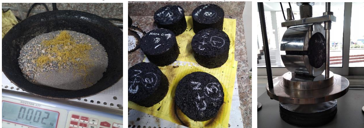
Figura 12 Marshall para mezcla asfáltica modificada
