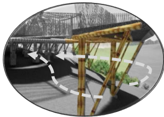
Elevación sobre el terreno, suelo húmedo
