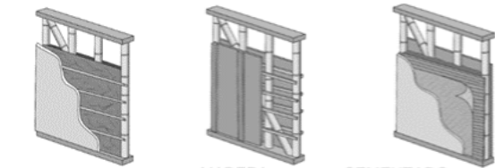
Tipologías de muros de bahareque, elaboración propia
