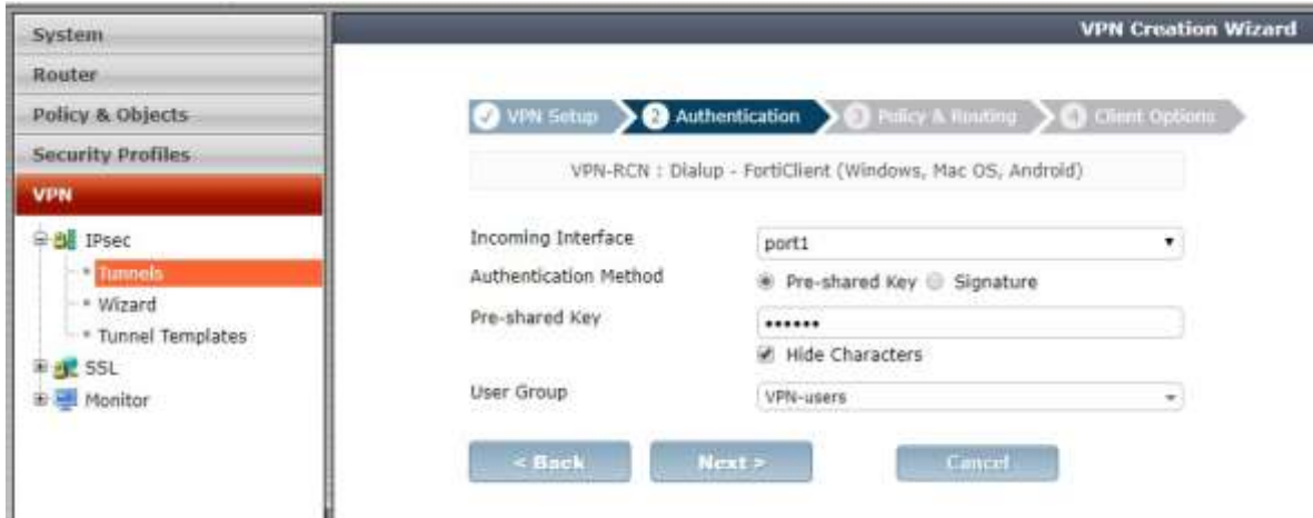
Figura 26: Configuración VPN IPsec
