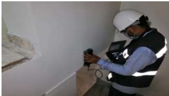
Ilustración 29 Ubicación de acero en viga con Ferroscan. Fuente: Elaboración propia.
