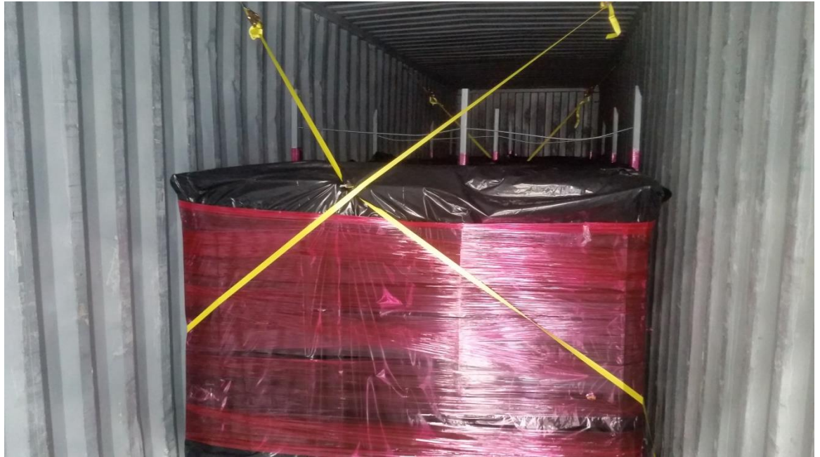
Figura 12 Interior de contenedor con módulos de vidrio
