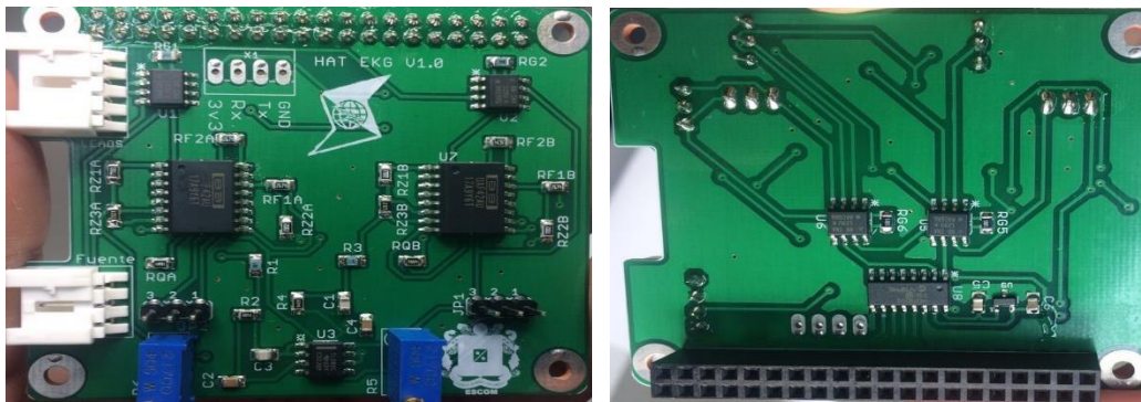
Figura 32 PCB a doble capa con los componentes soldados Fuente: Elaboración Propia
