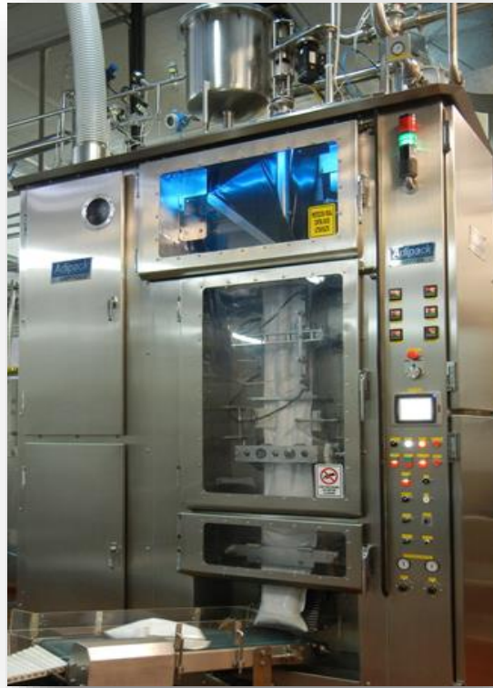
Figura 3. Envasadora Aséptica Versión 5 Litros. Adaptado del portafolio de Adipack LTDA.
