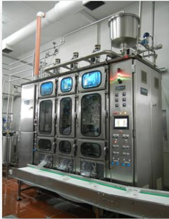
Figura 2. Envasadora Aséptica Versión 1 Litro. Adaptado del portafolio de Adipack LTDA.
