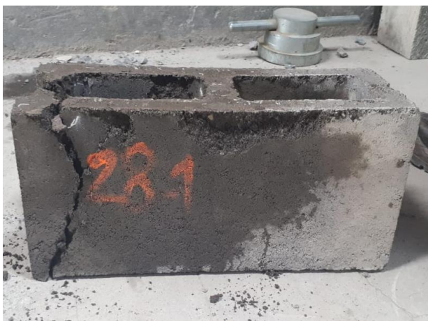
Figura 23 y Figura 24. Bloque patrón y bloque R50 después de realizado el ensayo de resistencia a la compresión. Fuente: Autores.
