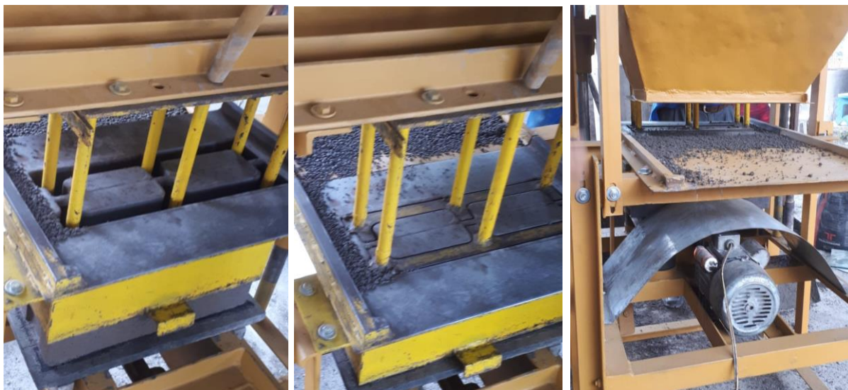
Figura 17, Figura 18 y Figura 19. Máquina vibrocompactadora para elaborar bloques. Fuente: Autores.
