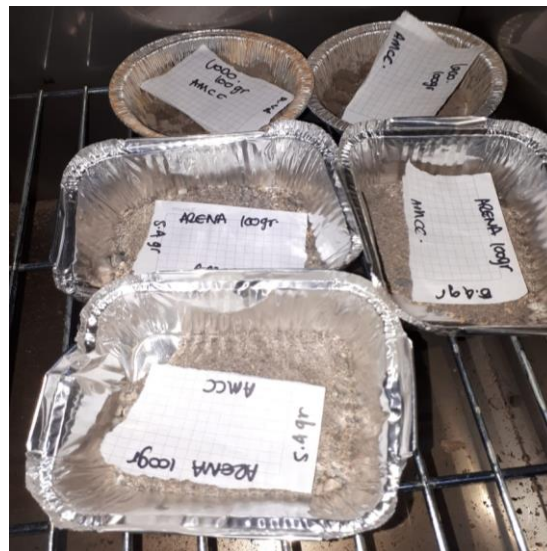
Figura 12. Muestras de arena y relave secadas en el horno durante el ensayo de contenido de humedad de los suelos.
