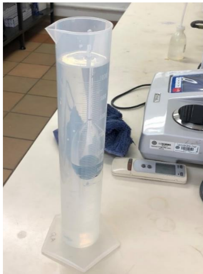
Figura 10. Lectura del hidrómetro + defloculante. Fuente: Autores.
