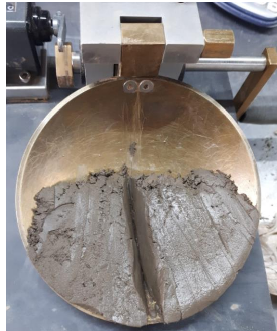
Figura 13 y Figura 14. Ensayo de limite liquido en la cazuela de Casagrande. Fuente: Autores.
