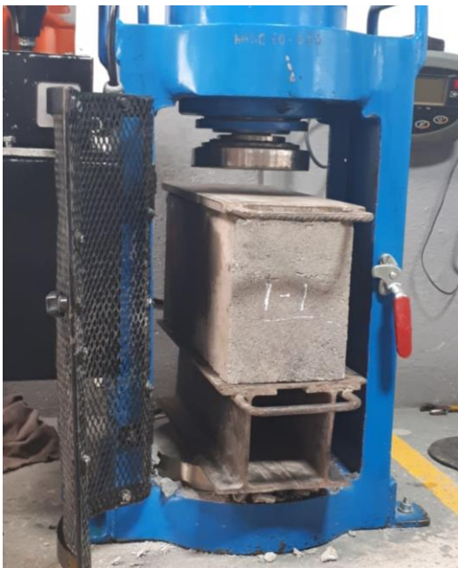
Figura 22. Esquema del ensayo de la resistencia a la compresión para bloques de concreto. Fuente: Autores.
