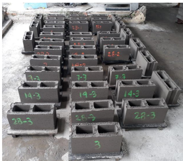
Figura 21. Bloques H-12 con y sin reemplazo porcentual de cemento durante el proceso de fraguado. Fuente: Autores.
