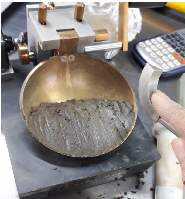
Figura 13 y Figura 14. Ensayo de limite liquido en la cazuela de Casagrande. Fuente: Autores.
