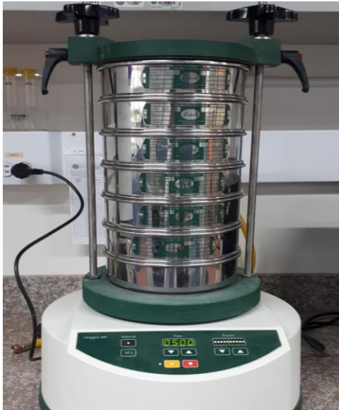
Figura 6. Tamizadora digital, utilizada en el ensayo de granulometría. Fuente: Autores.
