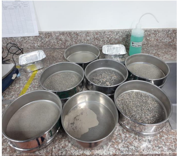
Figura 7. Juego de tamices después de realizado el ensayo de granulometría de la arena. Fuente: Autores.
