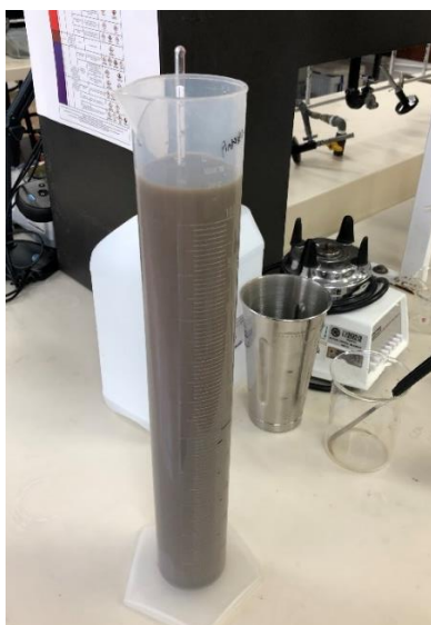
Figura 10. Lectura del hidrómetro + defloculante. Fuente: Autores.
