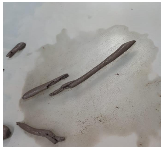
Figura 16. Ensayo de limite plástico. Fuente Autores.
