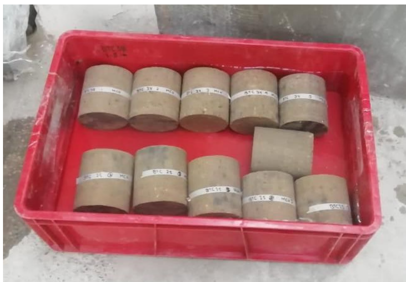
Ilustración 4. Inmersión de probetas para ensayo de resistencia a la compresión. Fuente: Propia
