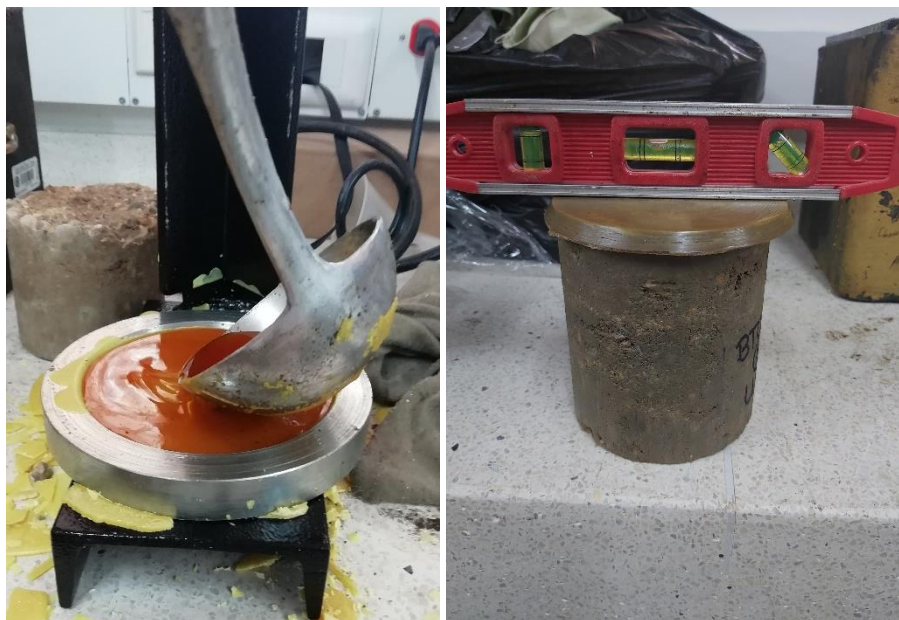
Ilustración 5. Capinado de probetas con azufre. Fuente: Propia
