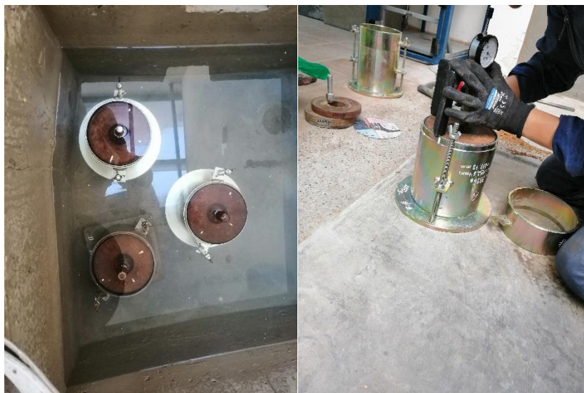
Ilustración 3. Inmersión y lectura del dial de las probetas para CBR. Fuente: Propia
