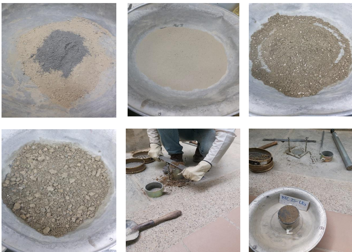
Ilustración 6. Ensayo de trabajabilidad para BTC-25 con 4% de cemento tipo UG marca Argos. Fuente: Propia.
